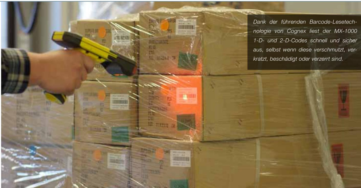
*Dank der führenden Barcode-Lesetechnologie von Cognex liest der MX-1000 1-D- und 2-D-Codes schnell und sicher aus, selbst wenn diese verschmutzt, verkratzt, beschädigt oder verzerrt sind.*
