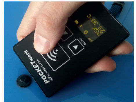
Passive Zustandsüberwachung in der Instandhaltung mit dem iID®POCKETwork und TELID®2x1 Sensor Transpondern
